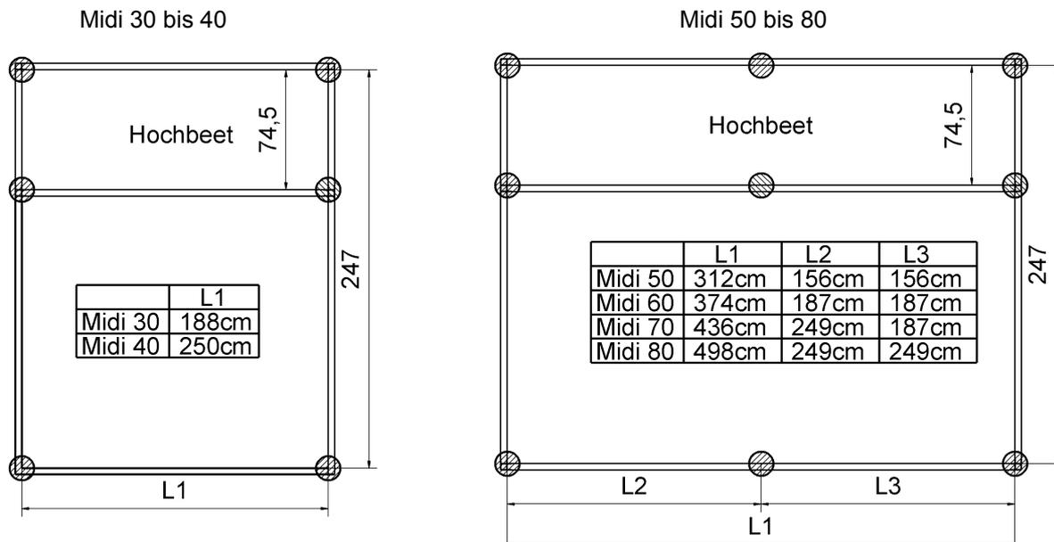
In diese Löcher werden Rohre von ca. 150mm Ø, Länge 40cm (z.B. KG Kunststoffrohre, nicht im Lieferumfang enthalten) einbetoniert. Dabei muss das Rohrinne bis zu einer Tiefe von 30cm frei bleiben!
